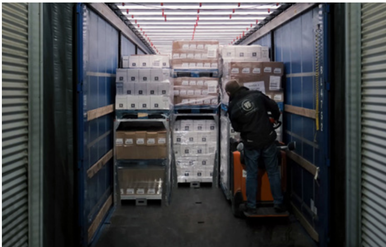
Tester har gjorts vid Midsonas anläggning i Mariager, Danmark, med att dubbelstapla pallar för att därigenom på bättre sätt använda transportutrymmet.
